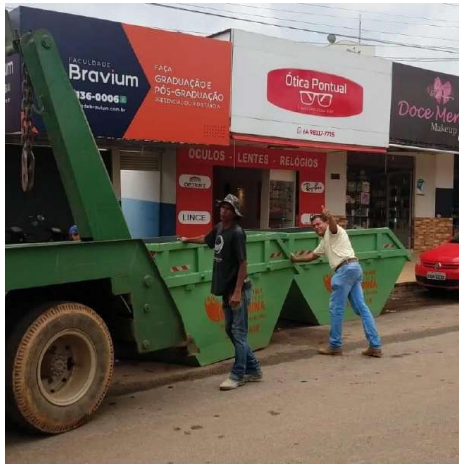
Figura 52. Caçambas para descarte de resíduos da construção civil.
