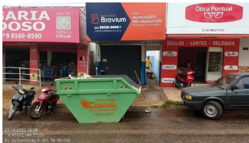
Figura 53. Caçambas para descarte de resíduos da construção civil.
